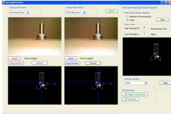
Figure 7. Canny Edge Detection
